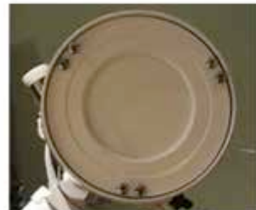
Vis de collimation (Ne pas dérégler)
