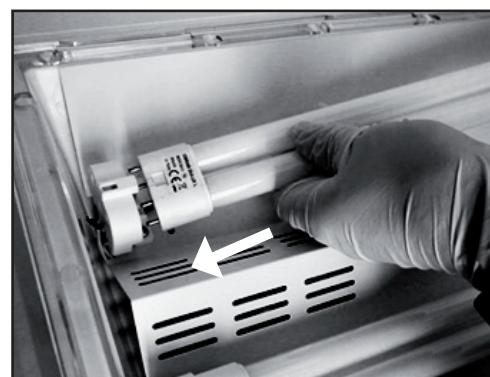
5. Legen Sie die neue Röhre in die Fassung und drücken Sie bis sie fest verankert ist. Die neue Röhre muss mit der alten übereinstimmen. Klappen Sie anschließend die Klammer über die durchsichtige Plastikröhre um diese zu schließen.
