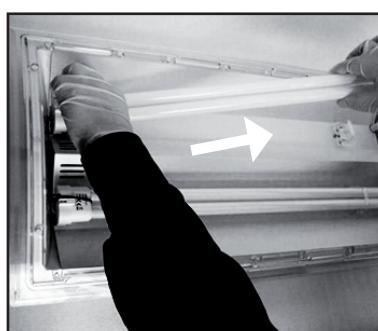
**4.** Retirer le tube : Relever l'arceau du support de tube puis couper avec un ciseau et jeter le collier de serrage noir à la base des tubes (il est juste utile en cas de choc lors du transport initial), saisir la base du tube puis tirer pour le déclipser.
