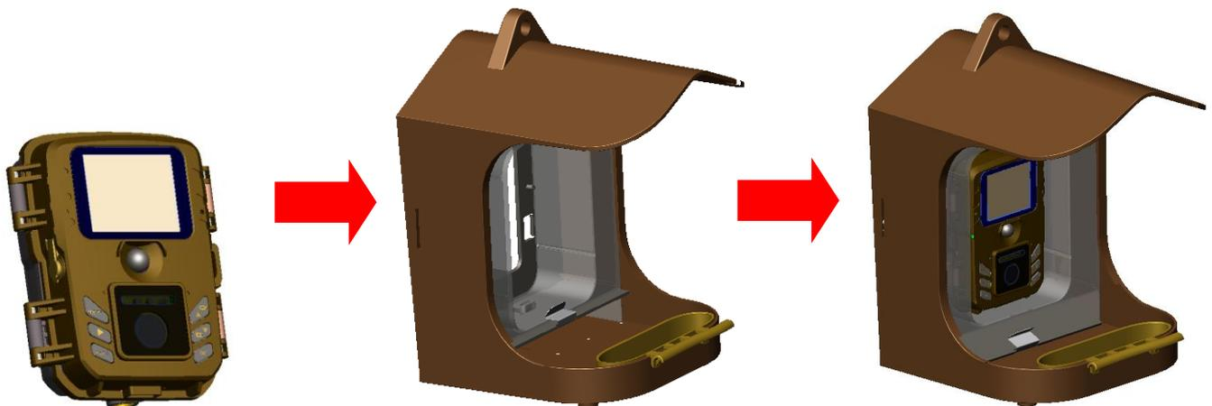
**Remarque :** ● Si vous souhaitez connecter une alimentation externe, vous devez le faire entre les étapes 7. et 8. Insérez le cordon d'alimentation avant la caméra dans le support de caméra en le passant par la sortie de cordon d'alimentation. Tirez l'autre extrémité du câble par la sortie, puis insérez la caméra de haut en bas dans le support de caméra du distributeur.
