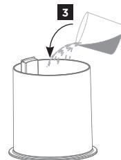
**3** Remplir le réservoir en veillant à ne pas dépasser la ligne de niveau d'eau maximum (90 ml).
