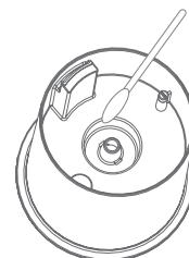
**5** Limpar e secar o interior do difusor com um pano macio e húmido. Limpe o difusor elétrico uma ou duas vezes por mês, colocando vinagre branco no reservatório de água e deixando esta solução até que todo o depósito calcário desapareça. Enxague bem. O difusor está novamente pronto a ser utilizado.
