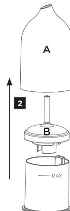
**2** Verwijder voorzichtig de buitenste keramische afdekking (**A**) en de binnenste afdekking (**B**).
