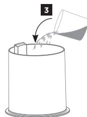
**3** Encha o reservatório, certificando-se de que não ultrapassa a linha do nível máximo de água (90 ml).
