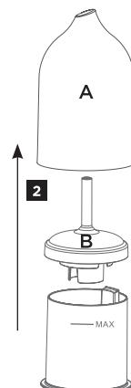
**2** Remova cuidadosamente a tampa externa de cerâmica (A) e a tampa interna (B).
