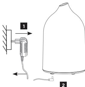
**1 | 2** Desligar e retirar o adaptador da tomada e, em seguida, o cabo de alimentação por baixo do difusor.
