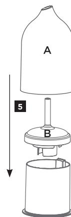
**5** Plaats de binnenste afdekking (**B**) en de keramische afdekking (**A**) terug.
