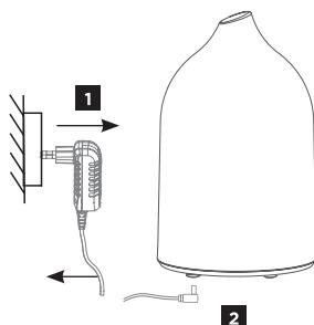
**1** **2** Eteindre et débrancher l'adaptateur de la prise secteur puis le câble d'alimentation sous le diffuseur.
