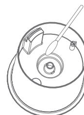
**5** Nettoyer et assécher l'intérieur du diffuseur avec un tissu doux et humide. Nettoyez le diffuseur électrique une à deux fois par mois en versant du vinaigre blanc dans le réservoir d'eau et en le laissant tremper jusqu'à ce que tout le tartre ait disparu. Bien rincer. Le diffuseur est à nouveau prêt à être utilisé.
