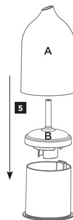
**5** Substitua a tampa interna (B), bem como a tampa de cerâmica (A).
