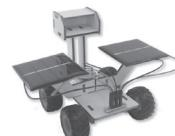
08 - Die Kabel des Motors und der zwei Solarmodule an der Stiftleiste anbringen. Die roten Kabel müssen alle auf einer Seite und die schwarzen Kabel auf der anderen Seite angebracht werden (auf welcher Seite die Motorkabel angebracht werden, ist beliebig, da sie lediglich beeinflussen, ob das Fahrzeug vorwärts oder rückwärts bewegt wird).
