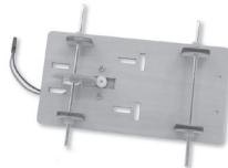
03 - Die Position von Zahnrad und Radachse so anpassen, dass sie sehr eng ineinander greifen.
