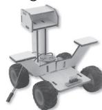
07 - Doppelseitiges Klebeband wie abgebildet auf beiden Seiten der kleinen Holzteile anbringen. Dann die Stiftleiste mit langen Schrauben an der in der Abbildung dargestellten Position anbringen.
