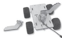
04 - Instale las piezas de madera juntas como se muestra en la figura. Los métodos de instalación de los lados izquierdo y derecho son los mismos.
