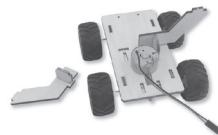
04 - Instale as peças de madeira juntas, como mostrado na figura. Os métodos de instalação dos lados esquerdo e direito são os mesmos.
