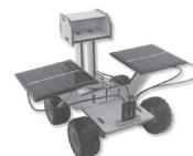
08 - Branchez les fils du moteur et des deux panneaux solaires aux broches. Les fils rouges sont branchés d'un côté et les noirs de l'autre (les fils du moteur peuvent être branchés librement, car cela n'affecte que les mouvements vers l'avant et vers l'arrière du véhicule).
